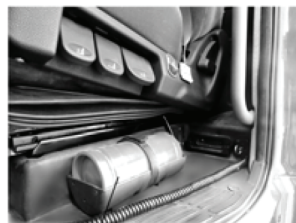
۱ - کپسول آتش نشانی
